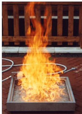
Figura 25 - Incêndio Classe “B”
