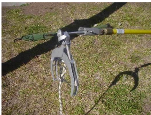
Figura 26 – Encaixe da garra na ponteira da vara de manobra
