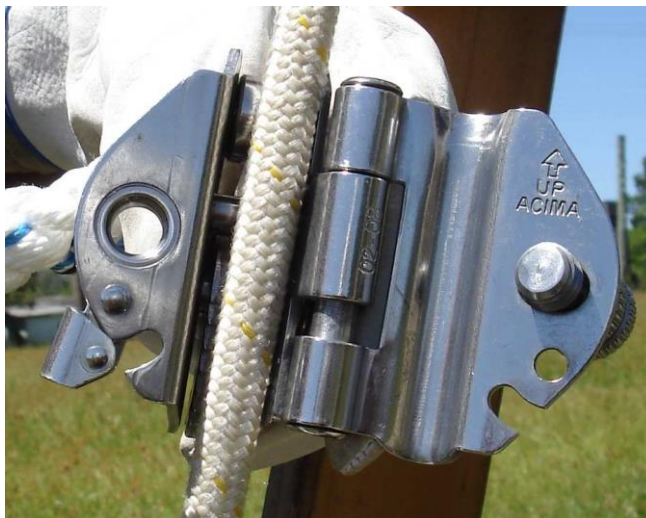
Figura 33 – Instalação do trava-quadras na linha de vida
