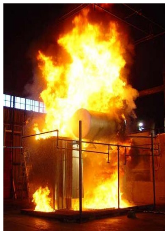
Figura 22 - Propagação do calor por irradiação
